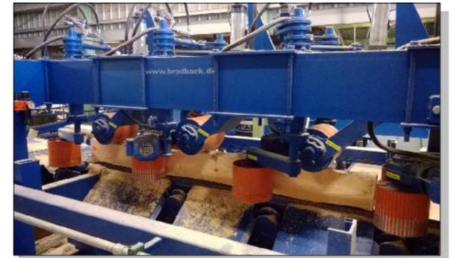
Brettabscheider nach einer Doppelwellenkreissäge
