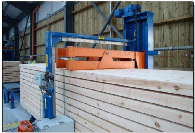
Integrierte Umreifungsanlage für fertige Pakete
