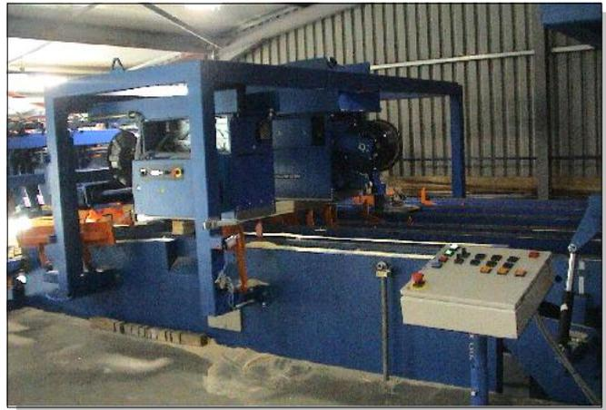
Bündelumreifer, integriert in eine Stapelanlage
