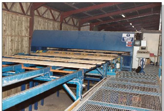
Scanner in einer Brødbæk Anlage
