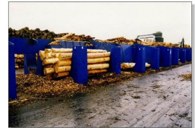
Rundholzsortieranlage mit Boxen für entrindetes Rundholz
