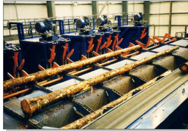
Hochleistungs-Durchlaufkappanlage für Langholz
