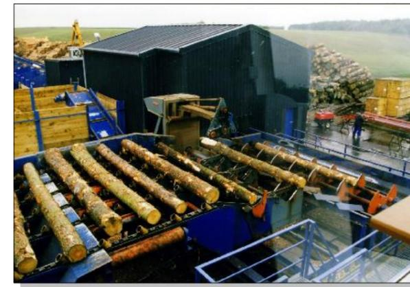
Rundholzanlage mit Wurzelreduzierung
